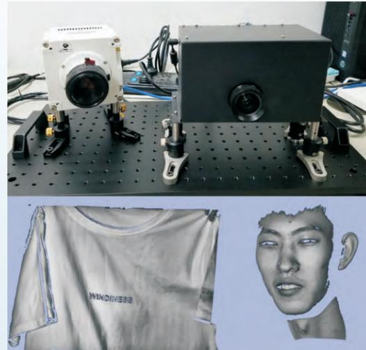
高分辨率高速 3D 扫描实验装置及高速捕捉的 3D 图像
