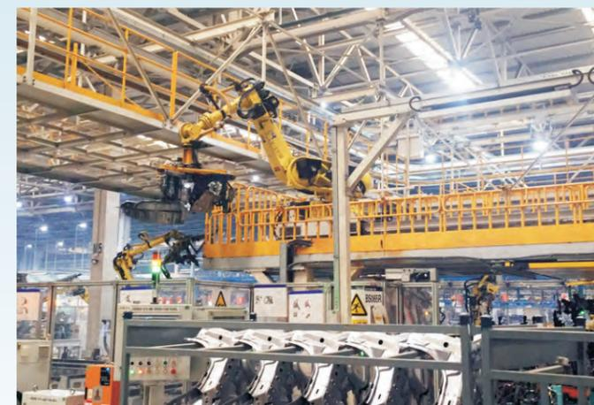
汽车自动化柔性焊装生产线
