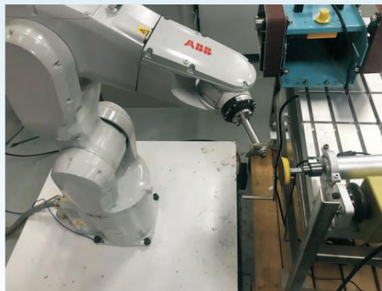
五金件抛光打磨机器人系统
