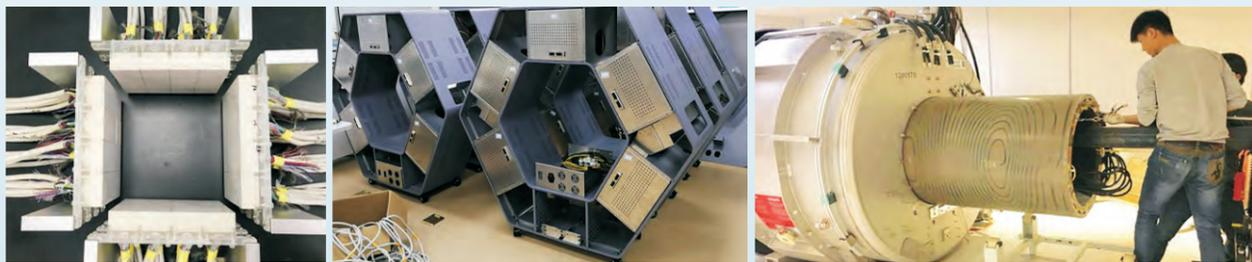
万通道超声辐射力发生器系统 千通道高精度超声神经调控电子系统 磁共振成像导航定位系统
